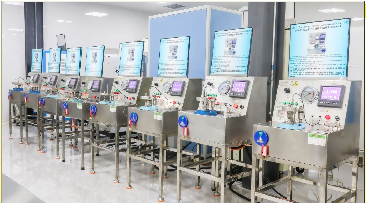
Batterie d'appareils de test de durée de vie de trains thermostatiques. Chaque appareil est équipé d'un enregistreur de paramètres et de nombre ce cycles. (Laboratoire Ultimheat).
